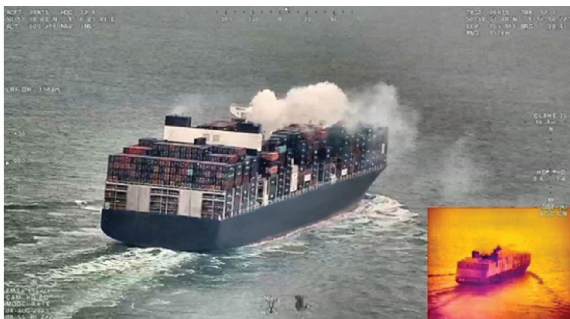
Figur 11 - Billede fra en drone, der nærmer sig et fartøj for at måle svovlindholdet i tætte dampe
