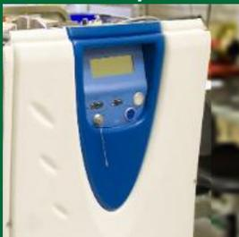
Las pilas de combustible convierten el hidrógeno en electricidad haciendo que reaccione con oxígeno procedente del aire. También pueden funcionar como electrolizadores, que utilizan electricidad para separar el agua. Constituyen la tecnología básica que se utiliza en el gas obtenido de fuentes renovables: el hidrógeno puede almacenarse durante meses, inyectarse en la red de gas o convertirse en gas natural.
