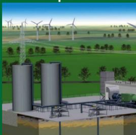
El almacenamiento de energía de aire comprimido utiliza cavernas subterráneas. En el modo de carga, el aire se comprime y se puede almacenar bajo tierra a altas presiones durante meses. El aire se libera y se expande en una turbina para volver a generar electricidad. Desde la década de 1970 se han implantado diseños de baja eficiencia. Se están desarrollando diseños de gran eficiencia, que también podrían almacenar el calor que se libera durante la compresión.
