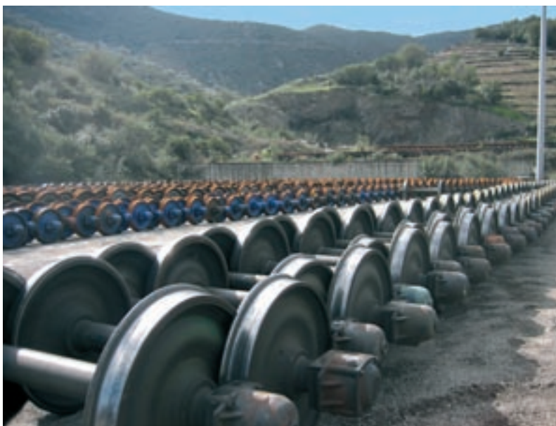
Fotografía 6. Ejes de vagones en las instalaciones de cambio de gálibo de Transfesa en Cerbère, en la frontera franco-española.
