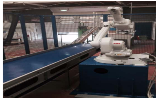
Un système de détection et de tri par caméra © Zeevisserijbedrijf Snoek bv, 2014
