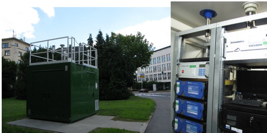
Monitorovací stanice kvality ovzduší a místa odběru vzorků (modrá zařízení na obrázku vpravo) Zdroj: EÚD.
