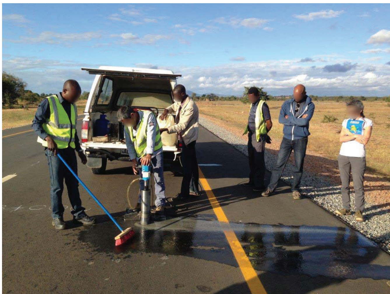
Rámeček 3 – Auditři prověřující přesnost měření tloušťky vozovky v souvislosti s platbou na projekt výstavby pozemní komunikace v Zambii
