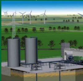
Per lo stoccaggio di energia ad aria compressa si utilizzano grotte sotterranee. Nella modalità di carica, l'aria viene compressa e può essere accumulata sottoterra ad alta pressione per diversi mesi. Una volta rilasciata, l'aria si espande in una turbina per rigenerare elettricità. Dagli anni '70 vengono utilizzati modelli a bassa efficienza. Modelli ad alta efficienza, che potrebbero anche accumulare il calore emesso durante la compressione, sono in fase di sviluppo.
