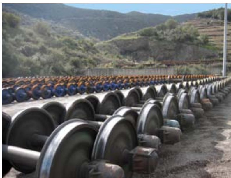
Снимка 6 — Складирани вагонни оси към съоръжението за промяна на междурелсието при Сербер, на границата между Франция и Испания
