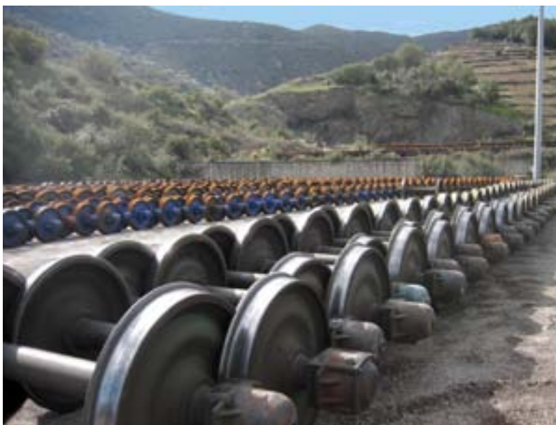
Fotografie 6 – Sklad železničních dvojkolí u zařízení na výměnu rozchodu společnosti TRANSFESA v Cerbère na francouzsko-španělské hranici
