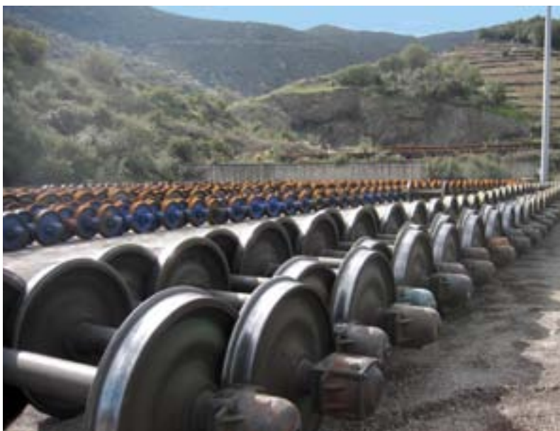
Foto 6 – Wagenachsenbestand an der Transfesa-Umspuranlage in Cerbère an der französisch-spanischen Grenze
