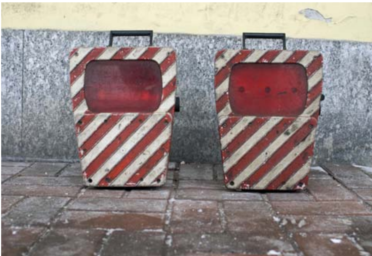
Foto 9 – Für den Betrieb in Italien vorgeschriebene Schlusslichter vor ihrer Anbringung am Bahnhof Brennersee
