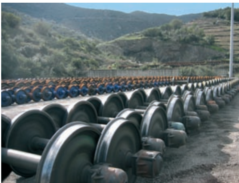
Φωτογραφία 6 – Απόθεμα αξόνων για άμαξες στην εγκατάσταση αλλαγής περιτυπώματος Transfesa στο Cerbère στα σύνορα Γαλλίας-Ισπανίας
