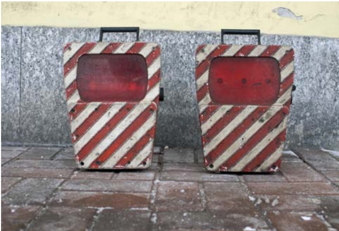
Foto 9. Itaalias nõutud tagatuled enne nende paigaldamist Brennersee jaamas
