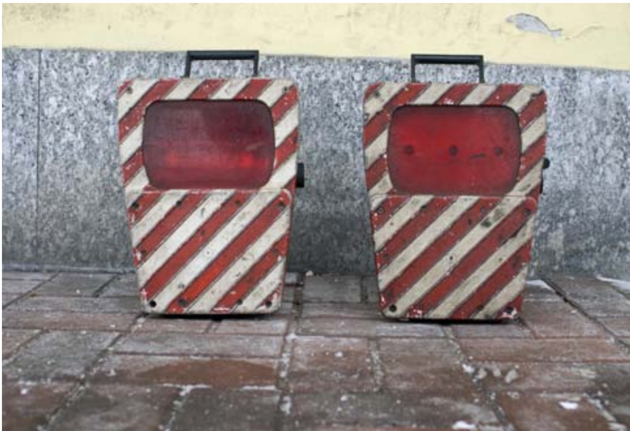
Kuva 9 – Italiassa edellytettävät perävalot odottavat kiinnitystä Brennerseen asemalla
