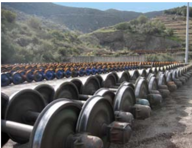
Kuva 6 – Vaunuakselivarasto TRANSFESAn raidelevyyden vaihtoalueella Cerbèresissä Ranskan ja Espanjan välisellä rajalla
