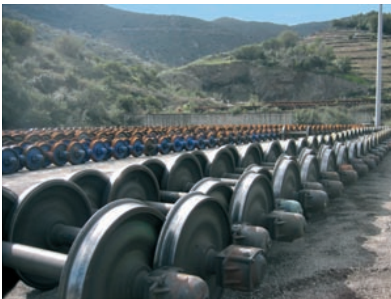
Ritratt 6 – Stokk tal-fusijiet tar-roti tal-vaguni fil-facilità tat-tibdil tal-gauge ta' TRANSFESA f'Cerbère fil-fruntiera bejn Franza u Spanja
