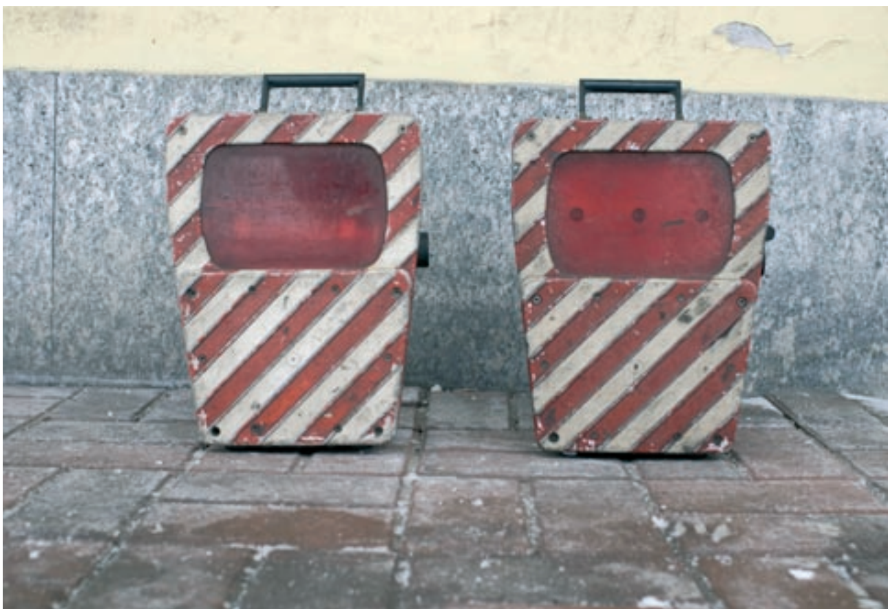
Ritratt 9 – Dwal ta' wara meħtieġa biex ferrovija topera fl-Italja qed jistennew li jitwaħħlu fl-istazzjon ta' Brennersee
