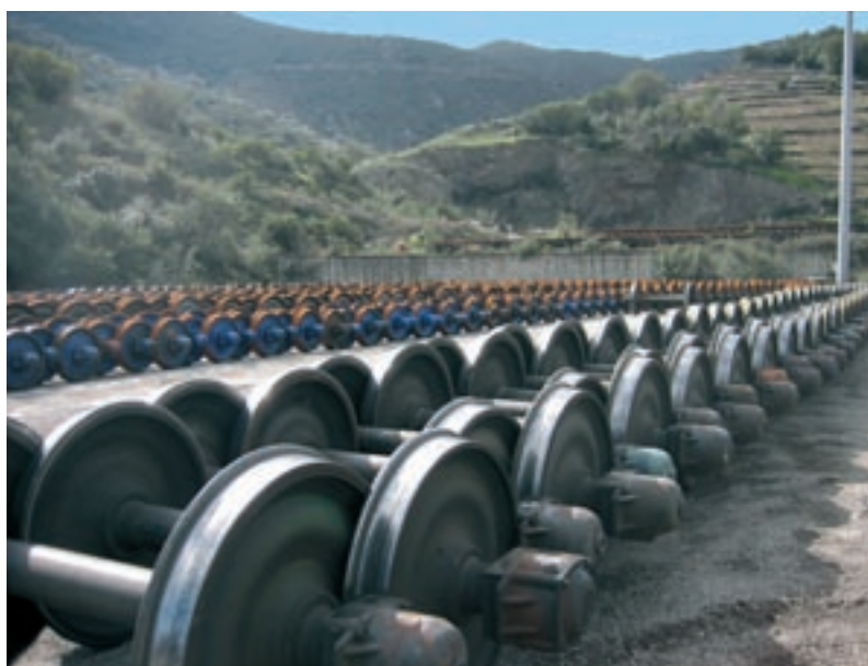
Fotografia 6 — Sortido de eixos de vagão nas instalações de mudança de bitola da Transfesa em Cerbère, fronteira França / Espanha
