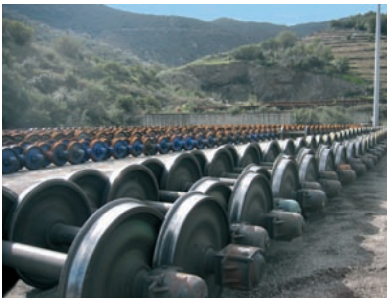
Fotografia 6 – Stoc de osii de vagoane la instalația de schimbare a ecartamentului TRANSFESA de la Cerbère, la frontiera dintre Franța și Spania
