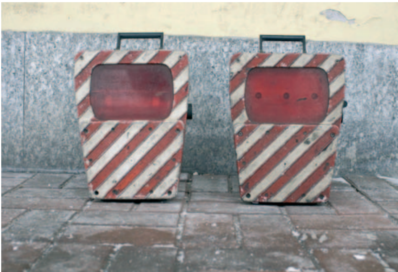
Fotografia 9 – Zadné svetlá, ktoré sa vyžadujú pri doprave v Taliansku, pripravené na pripevnenie na stanici pri Brennersee
