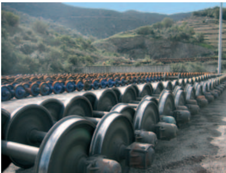
Fotografia 6 – Skladisko vagónových náprav pri zariadení na výmenu rozchodu koľají TRANSFESA v Cerbère na francúzsko-španielskej hranici
