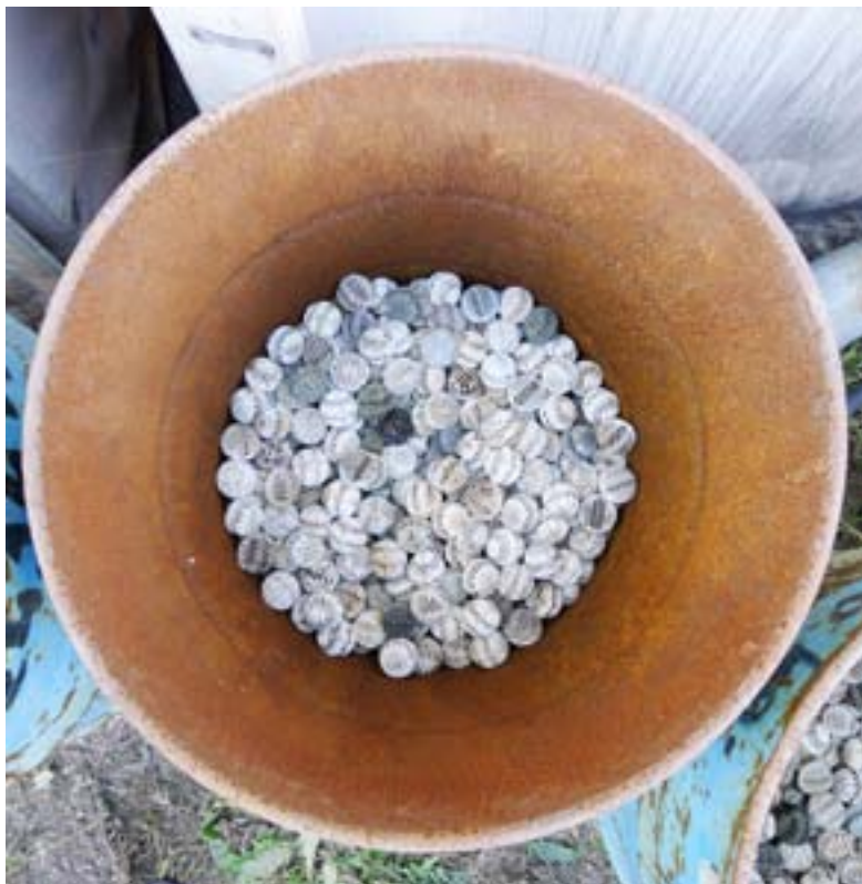
Foto 9 – Tunna med gjutna plastbollar som används till att extrahera föroreningar under jord i ett förorenat område (Dunaujvaros i Ungern).
