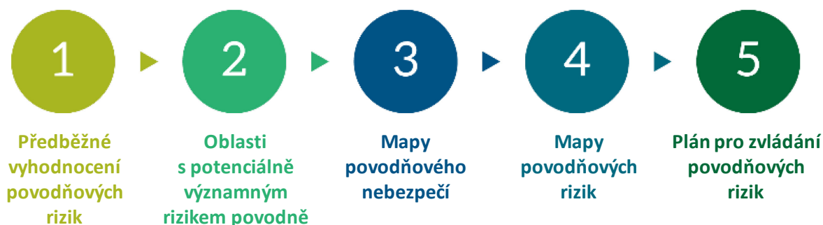
Obrázek 5 – Pětistupňový postup vyhodnocování a řízení rizik, který požaduje směrnice o povodních
