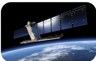
Die Mission **Sentinel-1** besteht aus zwei polarumlaufenden Radar-Satelliten (1A und 1B), die ein Mikrowellensignal zur Erde aussenden und das von dort zurückgeworfene Signal messen, ohne von vorhandenen Wolken behindert zu werden.
