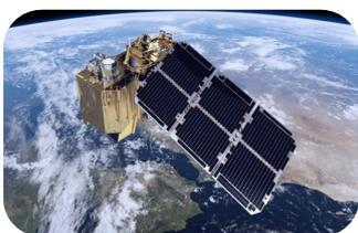
Die Mission **Sentinel-2** besteht aus zwei polarumlaufenden Satelliten (2A und 2B), die das von der Erde reflektierte sichtbare und Infrarotlicht in 13 verschiedenen Wellenlängen messen.
